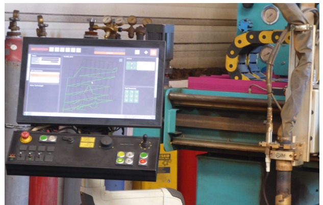
Retrofit von Brennschneidmaschinen: SAEHSEN Industrie-Service
